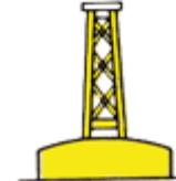
Grenzt die Reede an die Steuerbord- oder Backbordseite eines Fahrwassers, so ist diese Seite der Reede mit der entsprechenden Fahrwasserseitenbezeichnung gekennzeichnet (Zeichen E.2.1 oder E.2.2), die unter einem waagerechten Strich zusätzlich den ausgeschriebenen oder abgekürzten Namen der Reede und gegebenenfalls eine Nummer anzeigt.
